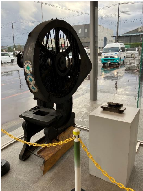
Fig. 1 打ち抜きに使用していたプレス機と金型
